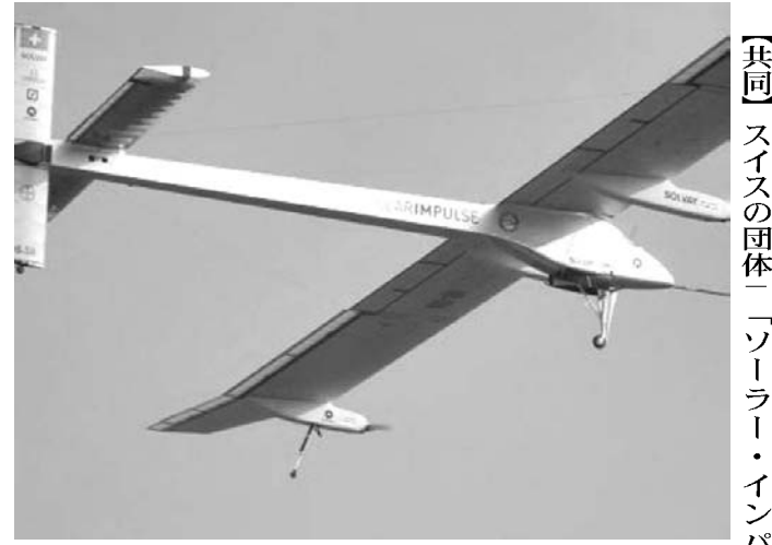
ソーラー飛行機は炭素繊維でつくられ重量わずか1.6トン(共同)
