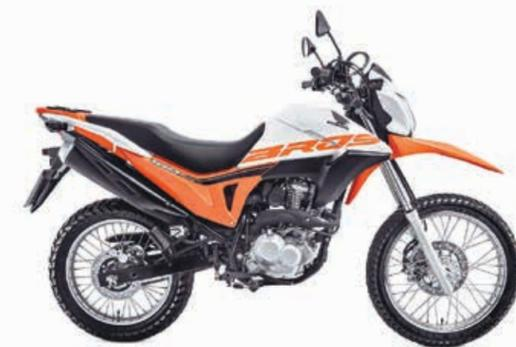
NXR 160 Bros tem motor OHC, monocilíndrico 4 tempos, com 14,5 cv de potência a 8.500 rpm com gasolina.
