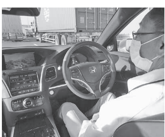
首都圏高速道路を走行するホンダの高級セダン「レジェンド」。渋滞時のみハンドルに手を触れず、視線をそらすことが可能になった。3月、東京都内(共同)
